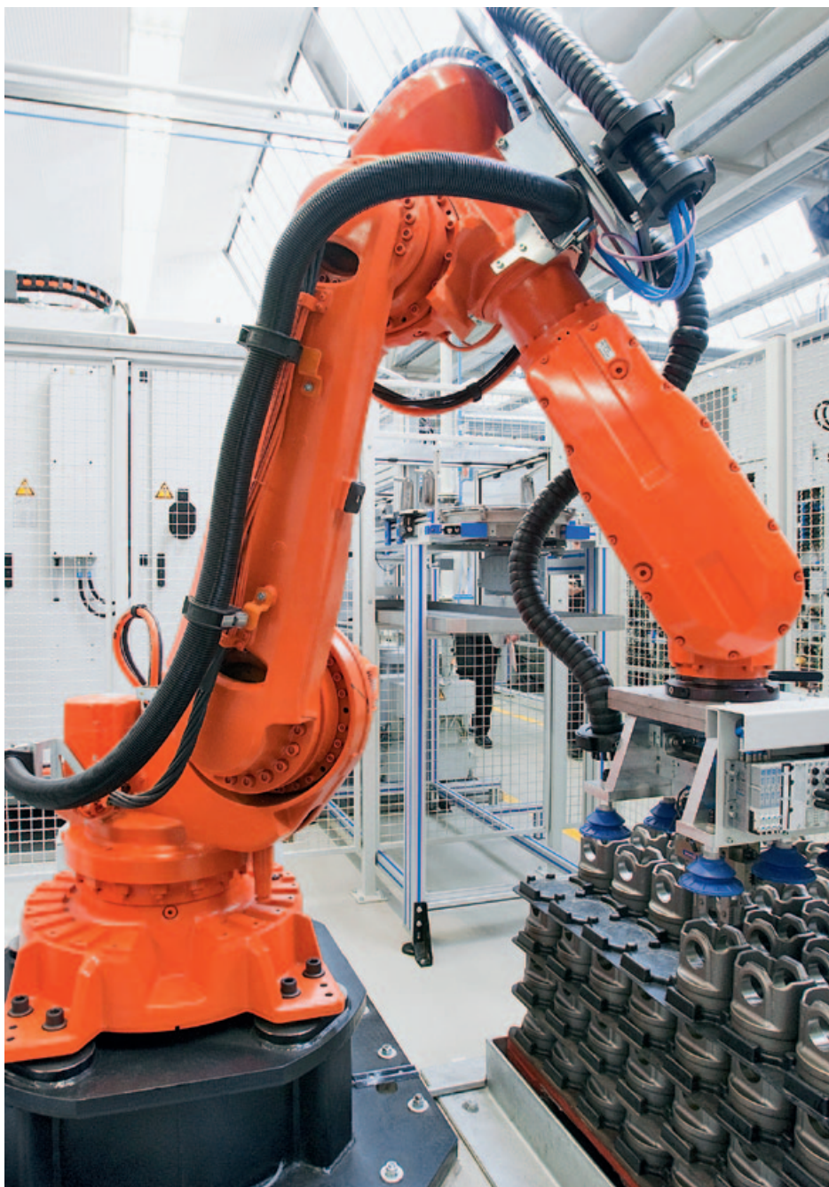
Die Entnahme der Kolbenrohlinge im MAHLE Werk in Rottweil erfolgt per Roboter. Im Robotergreifer ist eine Kamera installiert, welche die Teile auf Geometrie, Position und Lage prüft.
