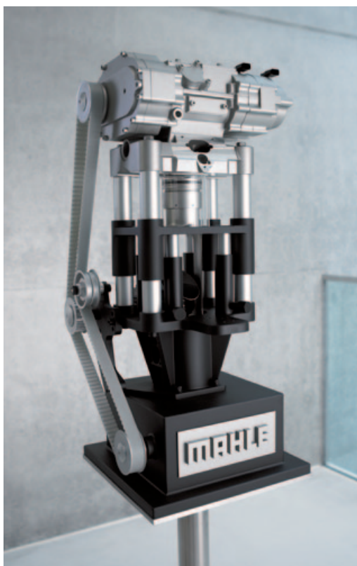
Einzyylinder-Forschungsmotor mit optischer Zugänglichkeit zum Verbrennungsraum im Zylinderkopf und Zylinder durch hochfeste Quarzzyylinderlaufbuchse sowie Pleuellbogen mit Saphirglasboden
