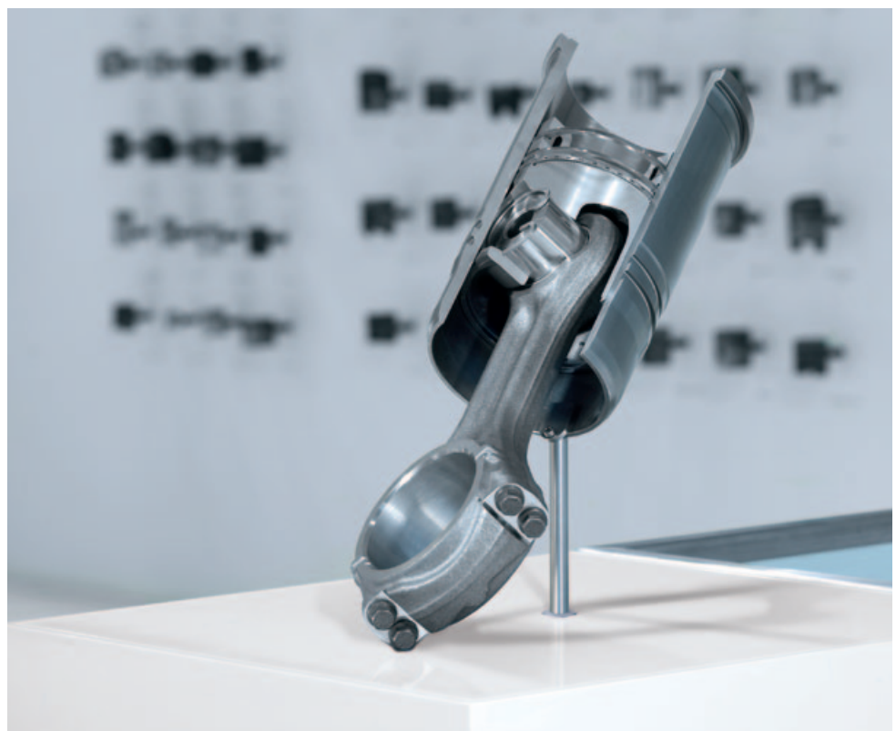
Kolben-Zylinder-Einheit für Nutzfahrzeuge bestehend aus Aluminiumkolben mit gekühltem Ringträger, Kolbenringen und Bolzen, Zylinderlaufbuchse und Pleuel
